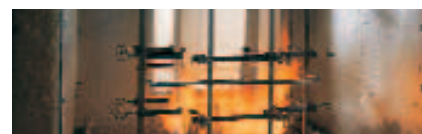
La base de la marca Trevira CS es el cumplimiento de las estrictas condiciones de la norma DIN 4102, clase B1, difícilmente inflamable.
