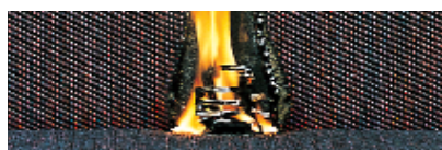
Para los edificios públicos se especifican ensayos con fuentes de ignición diversas, como esta consistente en un montón de madera ardiendo sobre la tapicería del mueble (BS 5852 II, crib 5).
